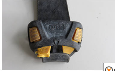
• バックルの破損
